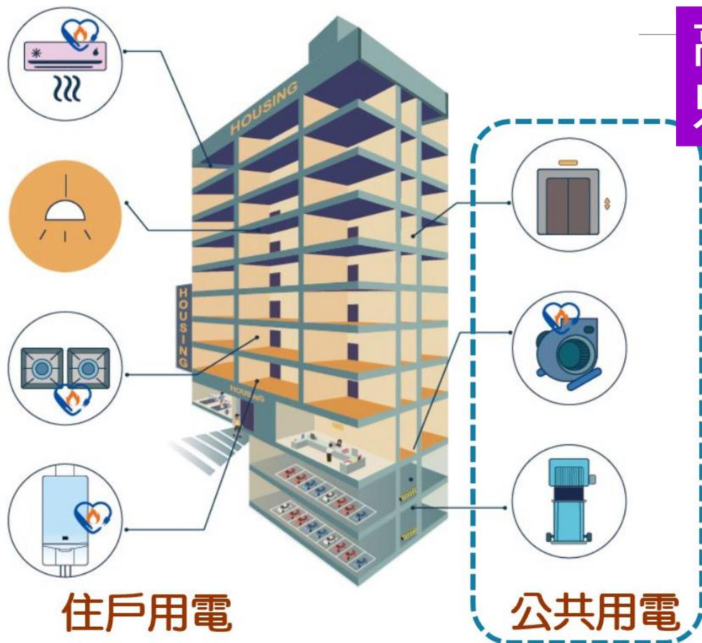
高層集合住宅公共用電佔總用電33~38%，只評估電梯、送水、停車場風機等耗電熱點
